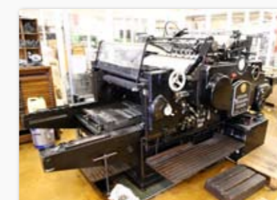
Heidelberg Cylinder för stansning.
