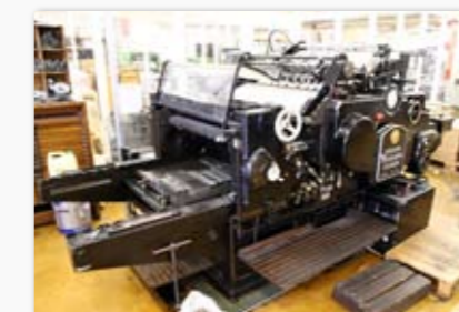
Heidelberg Cylinder för stansning.
