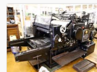
Heidelberg Cylinder för stansning.
