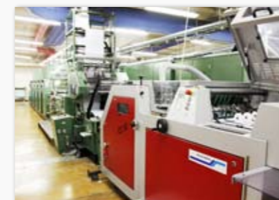
Grapfa Müller, 5-färgs rotationspress. Arkenhet modell Q 52(high speed). Maxkapacitet på 40.000 ex / tim.
